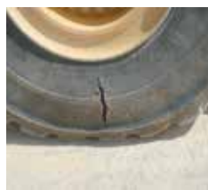
Naprawa pęknięcia i rozerwania
