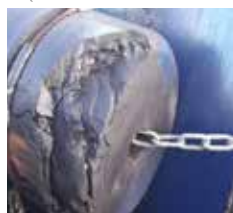
Odbudowa uszkodzonej części
