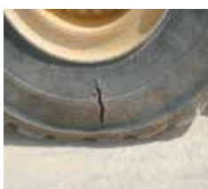
Naprawa pęknięcia i rozerwania
