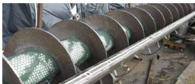
Podajnik ślimakowy naprawiony z użyciem materiału Belzona 1813 i pyłek z tlenku glinu
