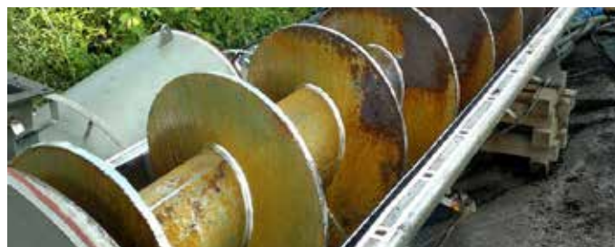
Uszkodzony podajnik ślimakowy
