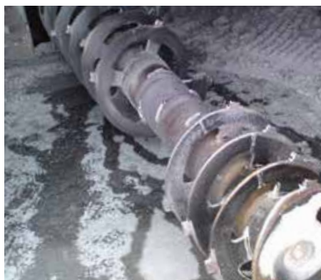
Przełożnik ślimakowy przed zastosowaniem powłoki
