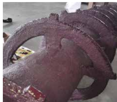
Przełożnik ślimakowy pokryty powłoką Belzona 1811
