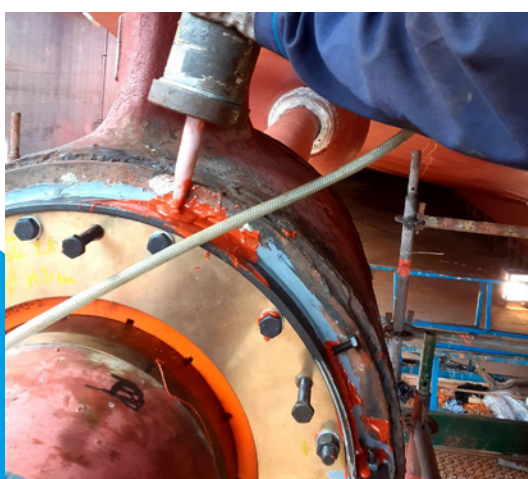
Osadzenie tulei łożyska w oprawie podpory okrętowego wału napędowego
