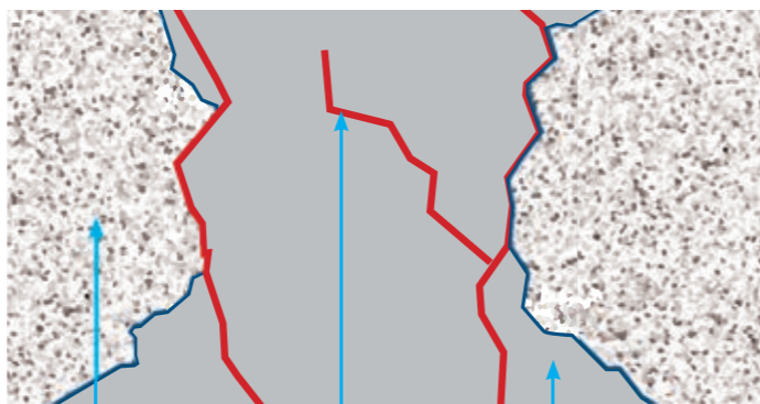
Rys.5. Przekrój struktury betonu z zaznaczeniem wypełniającego działania Belzona®4151.
