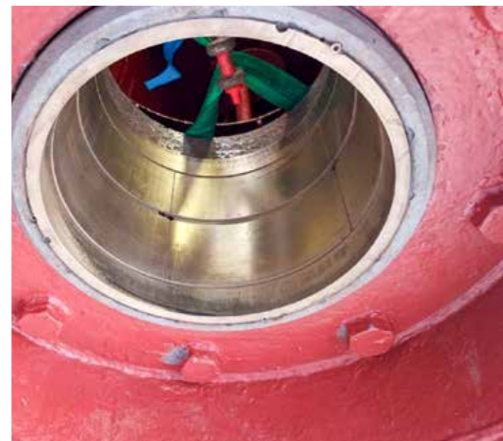
Fot.2. Klasykne osadzenie dociskowe tulei brązowej trzonu steru
