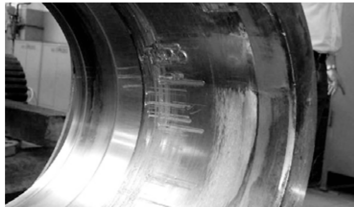
Fot.1. Ślady uszkodzeń wywołanych poślizgiem między powierzchniami oprawy/gniazda połączenia dociskowego
