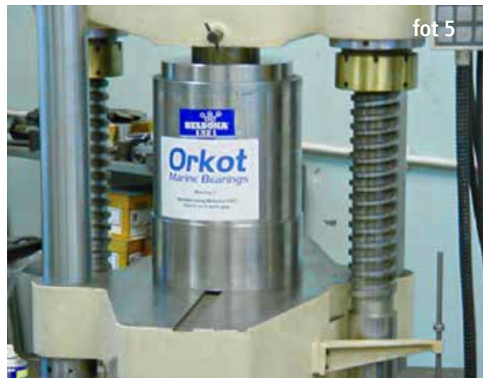
Fot.5. Stanowisko do próby wytrzymałościowej z zamocowanym modelem testowym osadzenia tulei w oprawie metalowej
