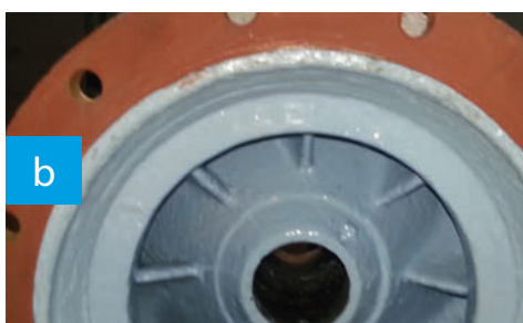
Fot. 2. Pompa pionowa typoszeru D (produkcji POWEN WAFAPOMP SA) po pokryciu powłoką kompozytową Belzona 1341 a) wirniki, b) kierownica, c) króciec redukcyjny, d) kolano wylotowe.
