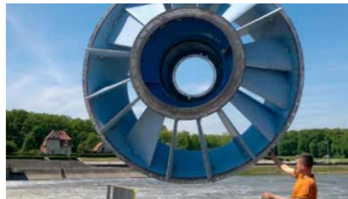
Fot. 3. Kierownica turbiny wodnej Kaplana (na Odrze) z powłoką kompozytową BELZONA 1341.
