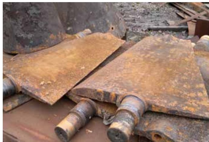
Fot. 1 Powierzchnia łopatki turbiny Kaplana po latach eksploatacji (rzeka Odra)
