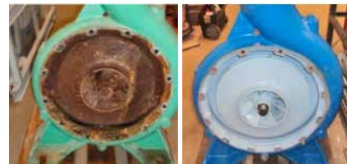
Fot. 4. Pompa o mocy 90 kW przed i po modernizacji z użyciem BELZONA 1341.
