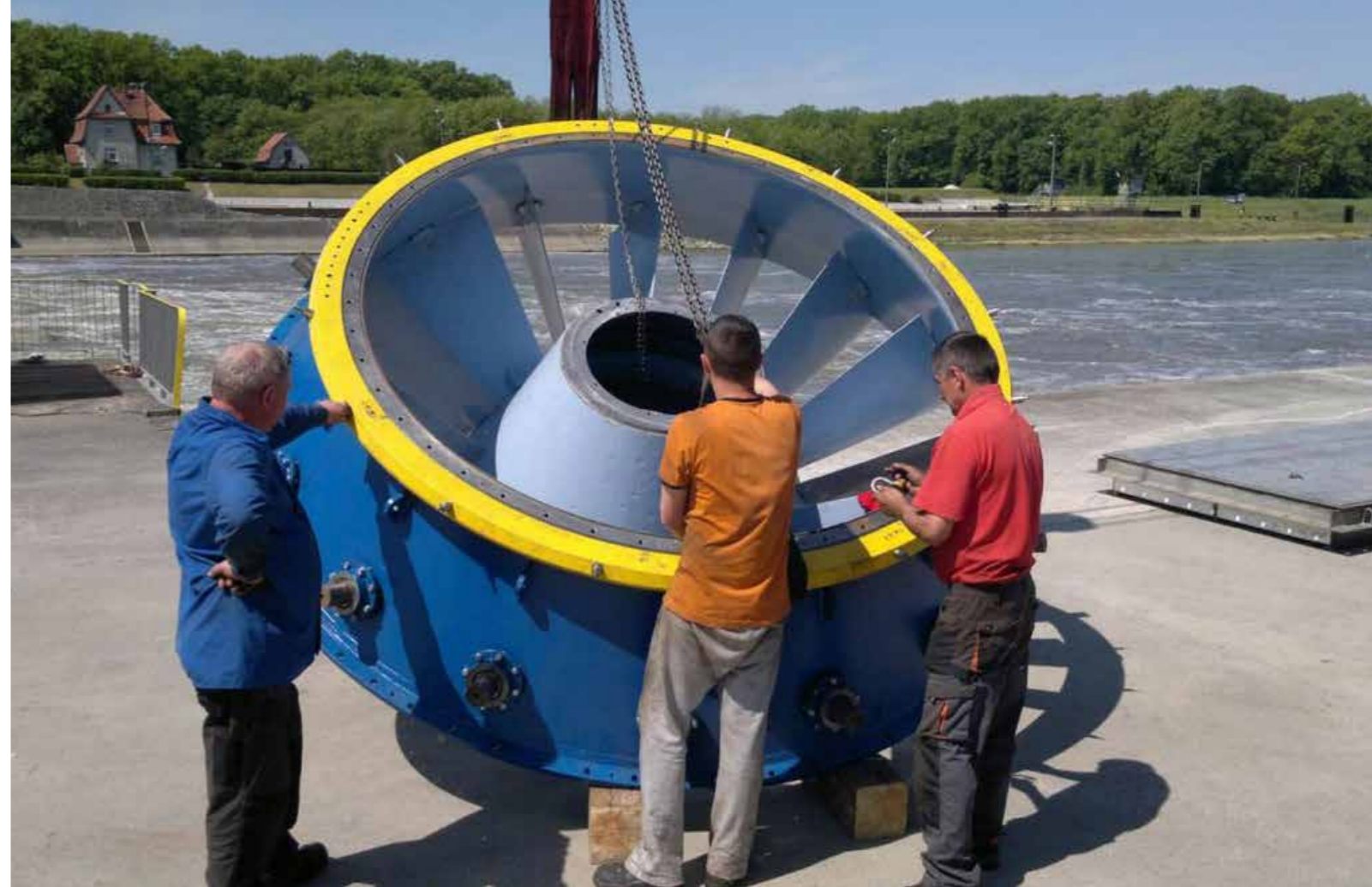
Fot. 2. Aparat kierowniczy turbiny wodnej z powłoką Belzona 1341
