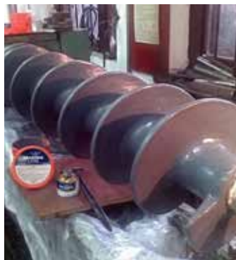
Zabezpieczenie podajników ślimakowych
