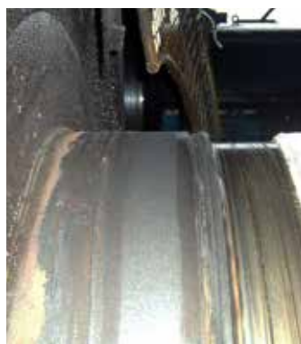
Naprawa powierzchni uszczelniającej
