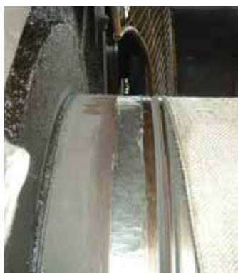
Zużyte powierzchnie uszczelniające
